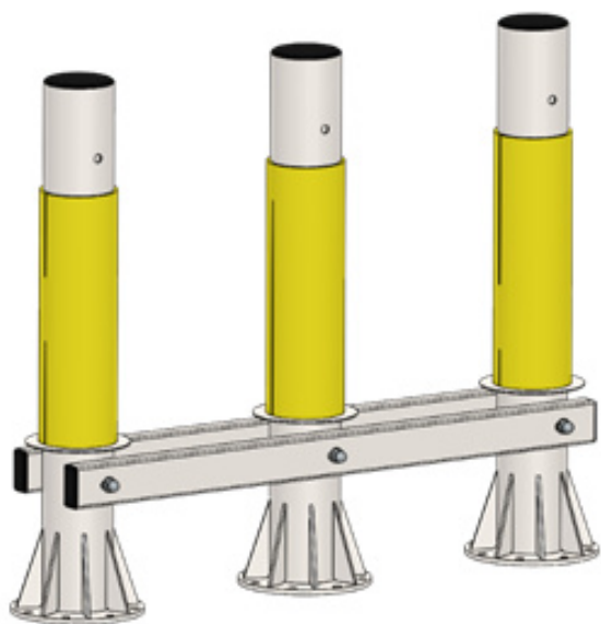
Рисунок 6. Надеть нижние перемычки и закрутить колпачки.
