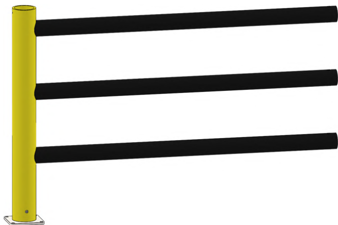
Рисунок 4. Установка трубы секции в концевой столб.
